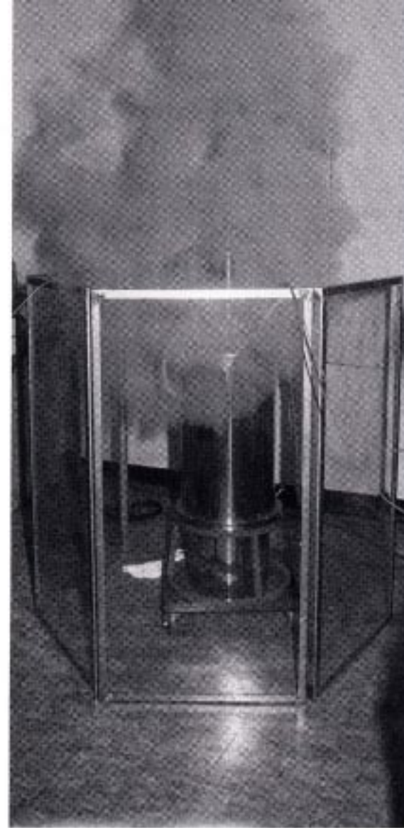
Figura 8 - Un "gejser magnetico": quando un criostato per misure su cavi superconduttori si accorge che essi non sono più tali
