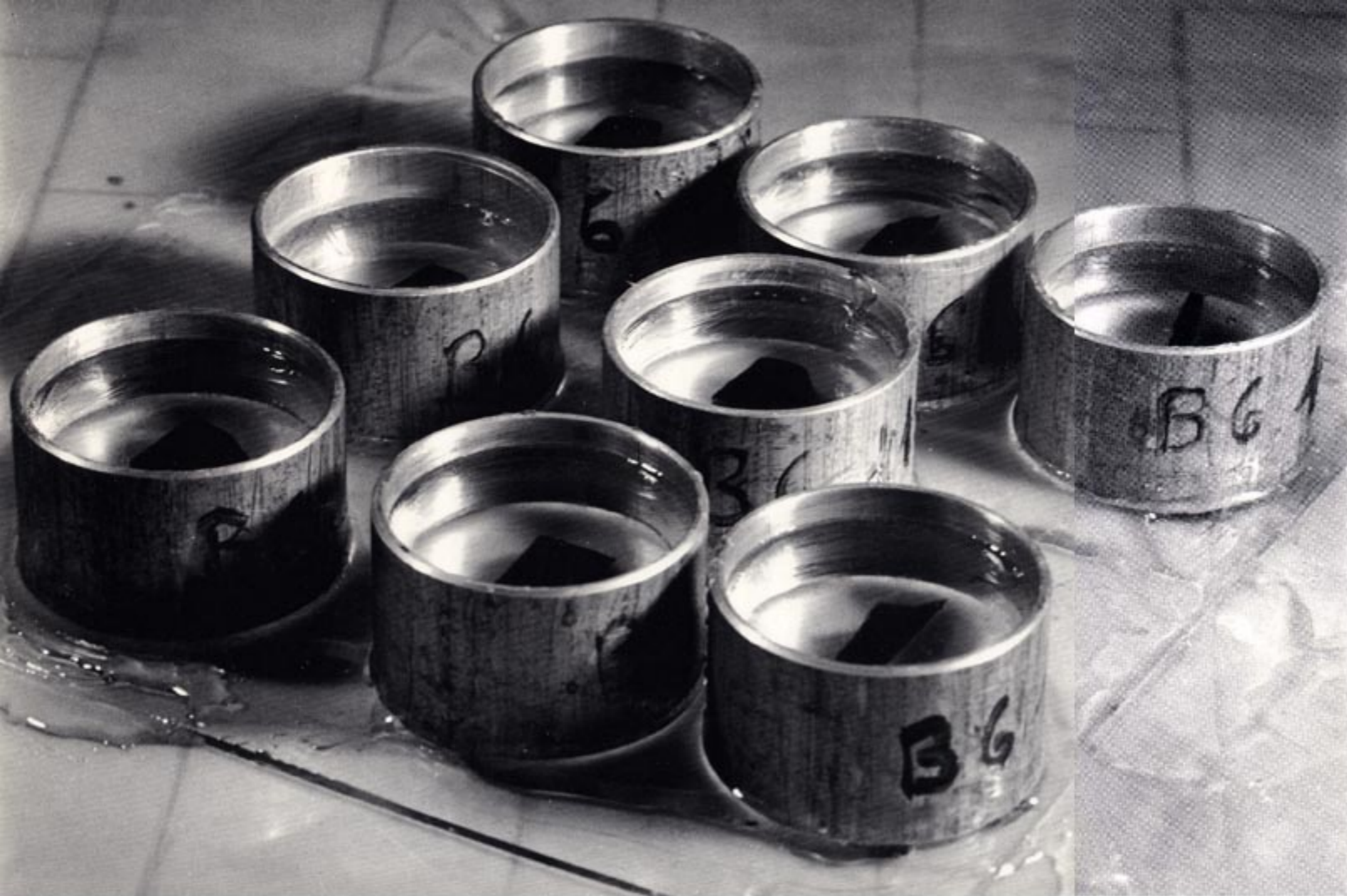
Figura 24 - Preparazione di campioni per l'osservazione metallografica
