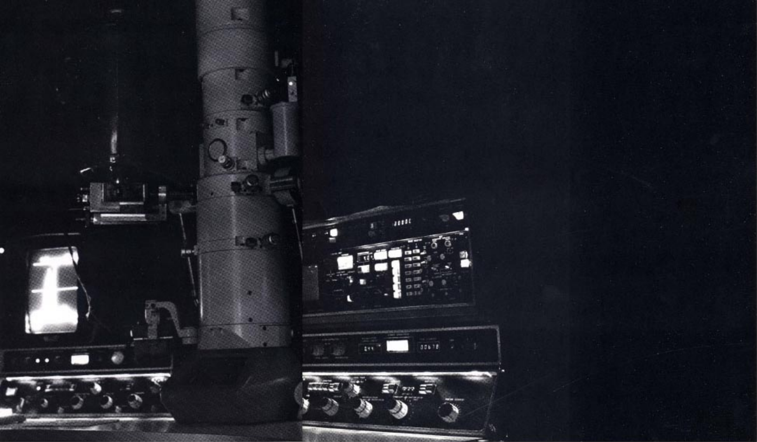
Figura 22 - Un "periscopio" puntato sulla struttura della materia: il microscopio elettronico a trasmissione
