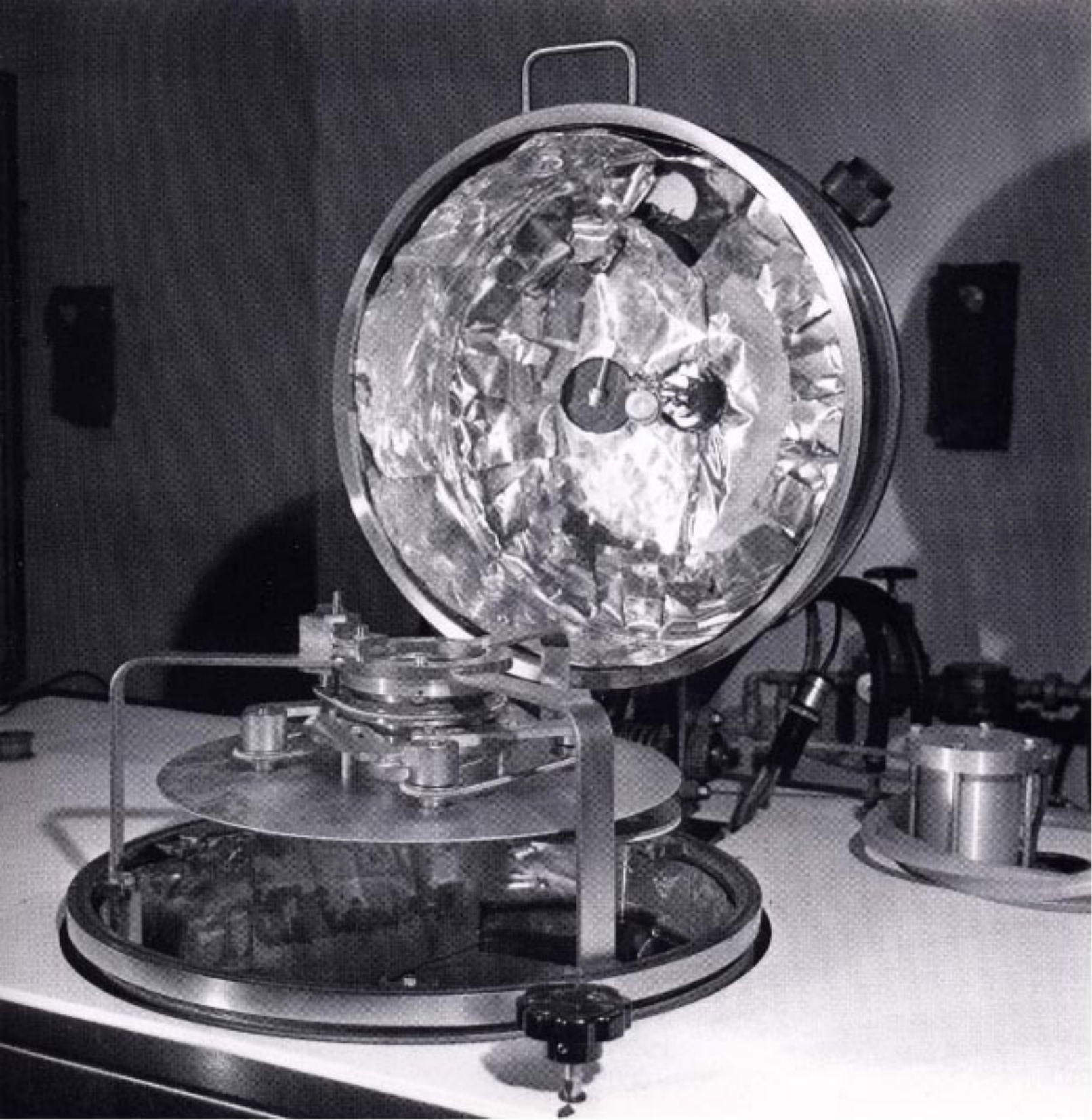
Figura 9 - "Chirurgia estetica" delle superficie dei materiali: camera aseptica per la preparazione di strati sottili di rivestimento
